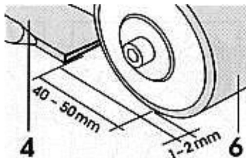
Проведите пробную сварку согласно рекомендациям производителя материала. Проверьте качество сварки. При необходимости подрегулируйте показатели температуры и скорости.
