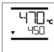
Температура сварки слишком высокая, А процесс охлаждения.
