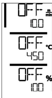
Если WELDY roof40 предварительно остыл, то после этого появится отображение последних заданных значений сварочных параметров. На этом этапе нагрев, подача воздуха и привод отключены.
